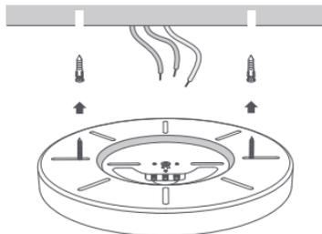
Variante b: Stellen Sie sicher, dass die Deckenhalterung richtig platziert ist. Führen Sie dann die Kabel von hinten durch die entsprechende Öffnung und befestigen Sie die Deckenhalterung mit den metrischen Schrauben an der Decke, so dass diese sicher fixiert ist.
