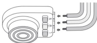
Entfernen Sie etwa 11–13 mm der Kabel-Ummantelung und verbinden Sie den Außenleiter mit Klemme L, den Neutralleiter mit Klemme N und den Schutzleiter mit Klemme PE (um die Stromkabel wieder zu entfernen, drücken Sie jeweils den roten Knopf über dem Loch der Anschlussklemme).
